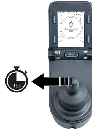
Foto 118. Empuje y mantenga presionado hacia la izquierda durante 15 segundos.
