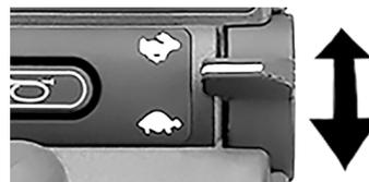
Foto 59. En el modo Bluetooth® la palanca derecha se utiliza para desplazarse hacia arriba o hacia abajo.
