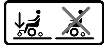
Foto 6. Las ruedas de apoyo siempre deben estar instaladas cuando maneja.
