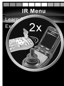
Foto 67. Apunte el control remoto hacia el receptor de IR. Presione el botón dos veces.
