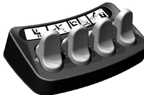
Foto 95. Paneles de control de asiento del ICS, el superior equipado con pulsadores y el inferior con interruptores de palanca.
