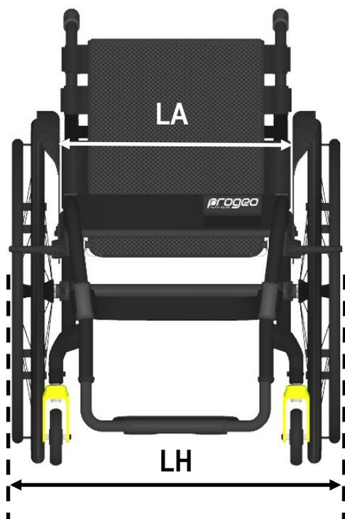
La largeur hors-tout minimale du fauteuil LH dépend de la largeur d'assise, mais également d'autres paramètres et composantes.
