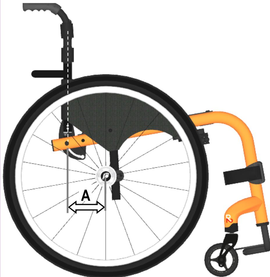
Le système de réglage coulissant du centre de gravité permet un réglage de la distance **A** au millimètre.
