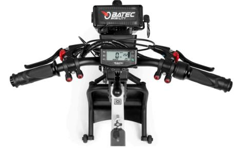
Guidon en aluminium noir mat avec commandes configurées pour utilisateurs paraplégiques, avec leviers de frein à gauche et à droite
