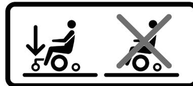
Illustration 6. Les roues d'appui doivent toujours être fixées lorsque vous conduisez.
