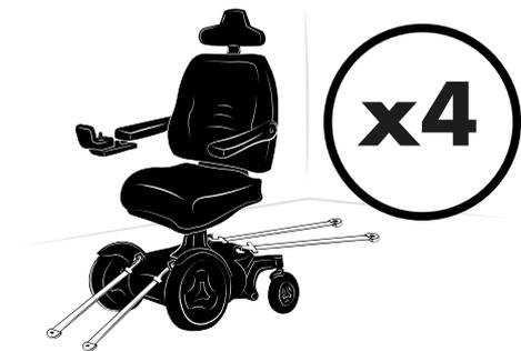
Illustration 167. Le fauteuil roulant a quatre points de fixation. Le fauteuil roulant et les emplacement des points de fixation sur cette illustration sont génériques.
