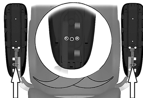
Bild 127. Justering av ändläge för armstödet lutning.
