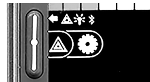
Bild 62. Knapp för att öppna inställningar i Bluetooth®-läge.
