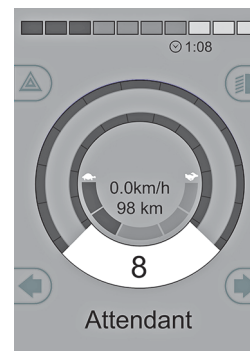
Bild 85. Standard displaybild med hastighetsindikator.
