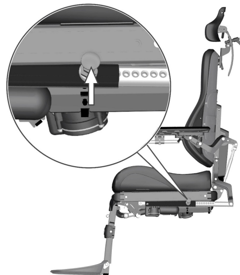
Bild 19. Manuell justering av ryggstöds vinkeln.
