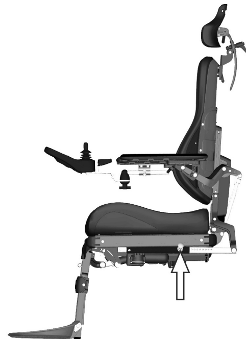
Bild 18. Manuellt ställbart låsrör för ryggstödslutning.
