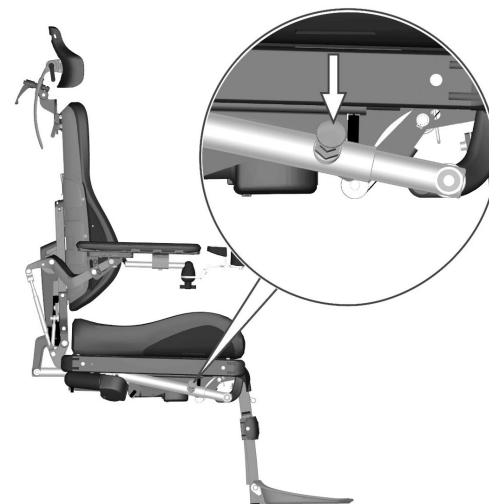
Bild 20. Manuell justering av benstödsvinkeln
