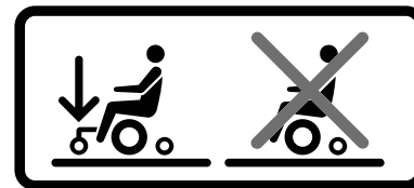
Bild 6. Stödhjulen måste alltid vara monterade när du kör.
