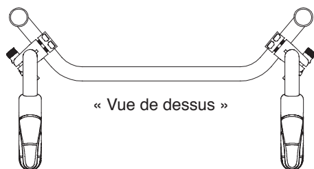
Figure 4-9 Poignées de poussée à hauteur réglable
