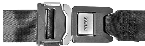
Bild 67. Bältesspänne ordentligt låst i snäpplåset.
