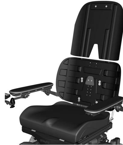
Illustration 136. La partie supérieure du dossier est sécurisée par un mécanisme de verrouillage.
