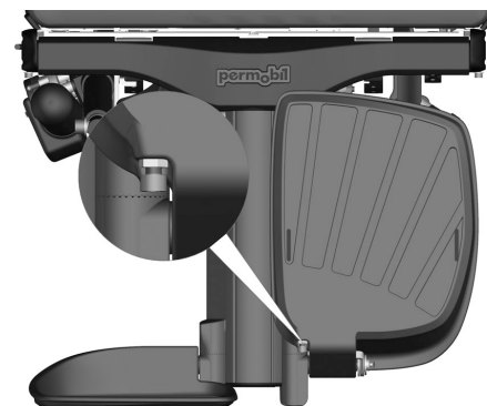
Illustration 108. L'angle des repose-pieds peut être réglé à l'aide d'une vis bloquée par un écrou de blocage.
