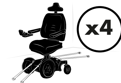
Illustration 132. Le fauteuil roulant est doté de quatre points d'attache. Le fauteuil roulant et l'emplacement des points d'attache dans cette image sont génériques.
