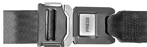
Illustration 118. Boucle de la ceinture correctement bloquée dans l'attache à déblocage rapide.
