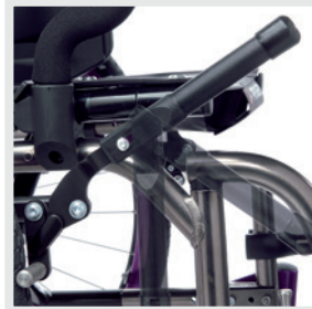
Bremse mit verlängertem Klapphebel, Betätigung nach vorne oder nach hinten
