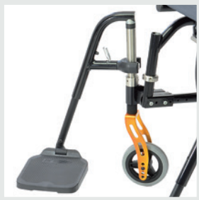
ULM-System, für Hemi- plegiker, die Fahr- richtung des Rollstuhls wird über die Fußplatte gesteuert, die mit der Achse der Gabel verbunden ist
