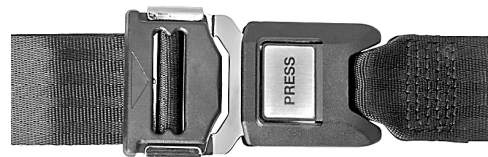
afb. 143. Gesp goed gesloten in de snelvergrendeling.
