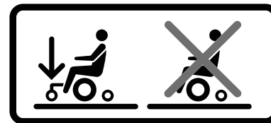
afb. 6. De steunwielen moeten altijd zijn bevestigd wanneer u rijdt.
