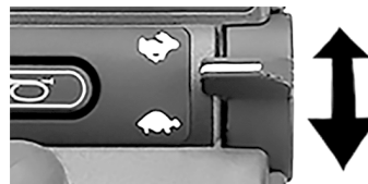
afb. 62. In Bluetooth®-modus wordt de rechter peddelschakelaar gebruikt om omhoog of omlaag te bladeren.
