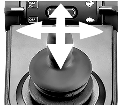
afb. 63. Met behulp van Bluetooth® kunt u met de joystick de muisfuncties uitvoeren.
