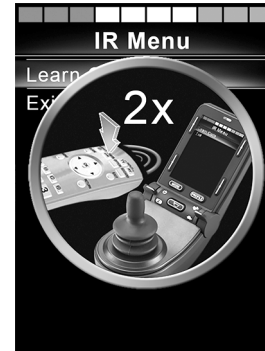
afb. 70. Richt de afstandsbediening op de IR-ontvanger. Druk de knop twee keer in.
