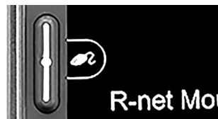
afb. 60. Linker knop om te klikken met linker muisknop.
