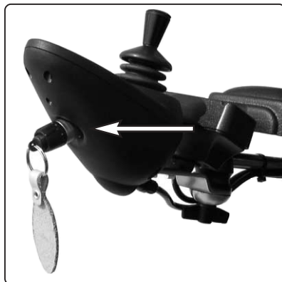
Billede 10. Paneludtag med sikkerhedsnøgle
