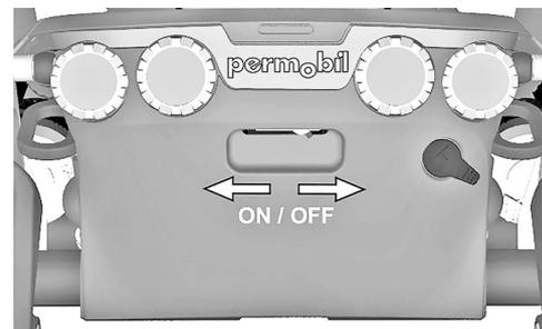
Foto 200. Interruptor automático situado bajo el logotipo de Permobil en la cubierta trasera.
