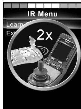
Foto 71. Apunte el control remoto hacia el receptor de IR. Presione el botón dos veces.
