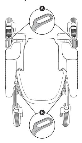
La silla de ruedas está equipada con cuatro puntos de fijación que se utilizan para el transporte A. Dos en la parte delantera 4 y dos en la parte trasera 6.
