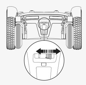
Si la va a guardar por mucho tiempo, cargue las baterías en su totalidad antes de su almacenamiento. Recuerde apagar el interruptor principal. Cargue las baterías cada mes. Tendrá que encender el interruptor principal para cargar las baterías, luego apagar el interruptor principal si la silla de ruedas va a permanecer almacenada.
