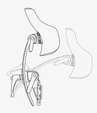
Así se ajusta la altura y la profundidad del apoyacabezas.
