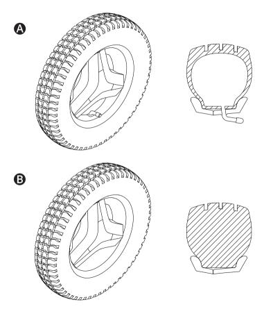
Las ruedas motrices de la silla de ruedas tienen neumáticos con cámara o antipinchazos (rellenos de espuma). Las ruedas giratorias tienen neumáticos de poliuretano sólido.
