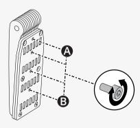
Así se ajusta la altura y la profundidad del apoyacabezas.
