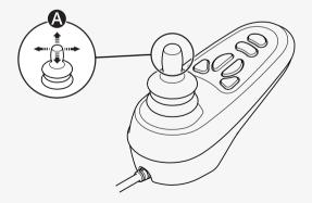
No mueva el joystick antes, durante o inmediatamente después de encender el sistema de control. Si mueve el joystick de esa manera, puede generar un error en el joystick. Si esto ocurre, apague y encienda la silla de ruedas.
