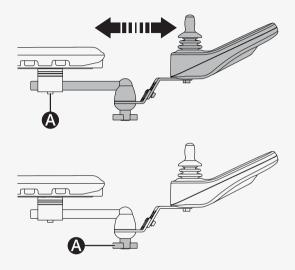
Puede inclinar el panel de control giratorio hacia cualquier lado. Así se ajusta el ángulo.
