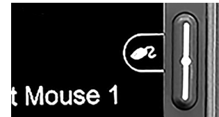
Abbildung 55. Rechte Taste für rechte Mausklicks.
