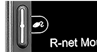
Abbildung 54. Linke Taste für linke Mausklicks.
