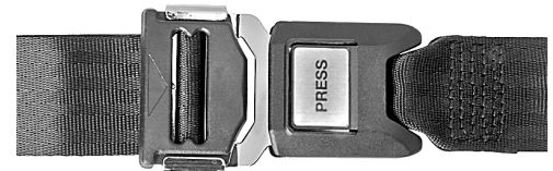
Abbildung 148. Gurtschnalle richtig in Schnellverriegelung verriegelt.
