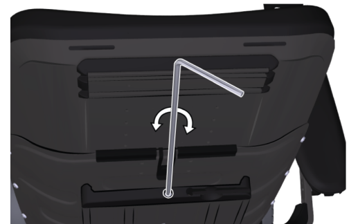
Abbildung 129. Verwenden Sie den mitgelieferten Einstellungsschlüssel.
