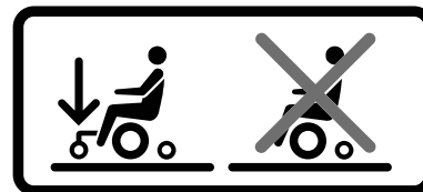
Abbildung 110. Die Stützräder müssen während der Fahrt stets angebracht sein.
