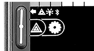
Abbildung 52. Taste zum Aufrufen der Einstellungen im Bluetooth®-Modus.
