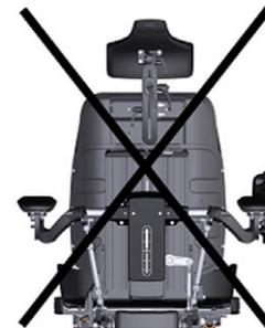
*Illustration 94. Le fauteuil ne doit être arrimé à aucun point de l'assise.*
