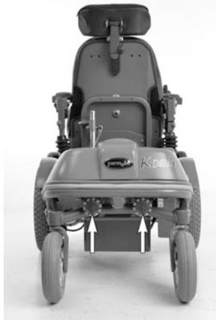
*Abbildung 4. Hintere Beleuchtung und Reflektoren.*
