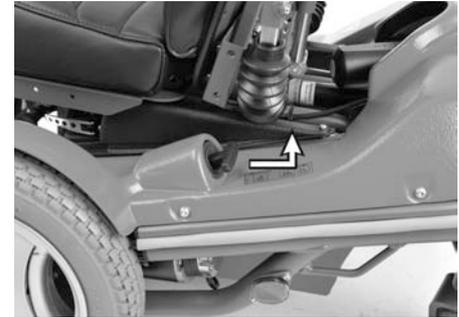
Abbildung 88. Bremsentriegelung.
