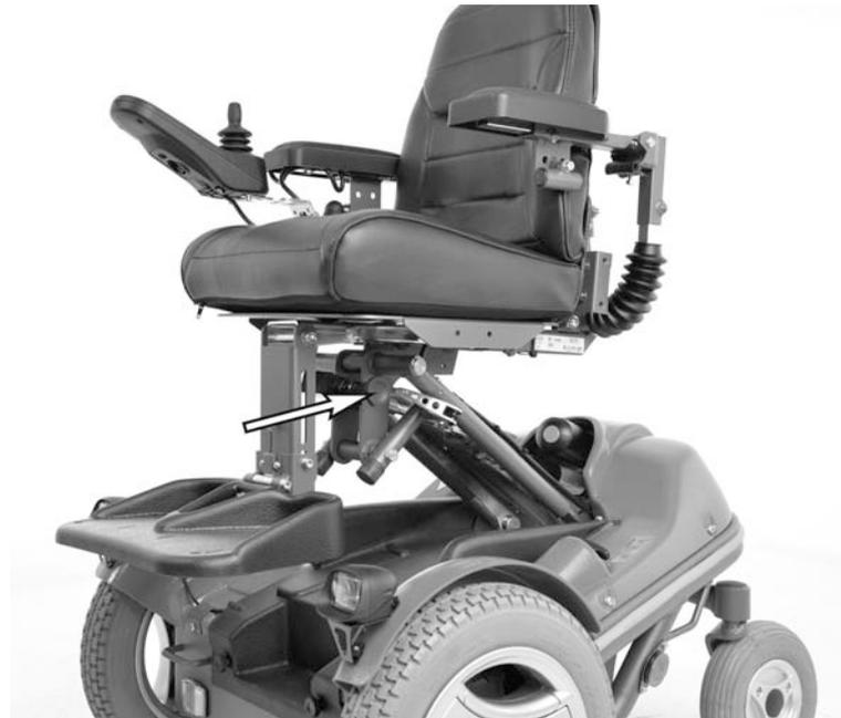
Abbildung 9. Elektrische Sitzhöhenverstellung und Sitzwinkelsperre.
