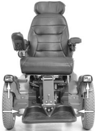
*Abbildung 3. Vordere Beleuchtung und Reflektoren.*
