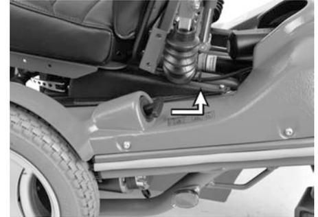
Abbildung 79. Bremsen entriegeln
