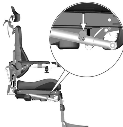
Foto 20. Ajuste manual del ángulo del soporte para las piernas.
