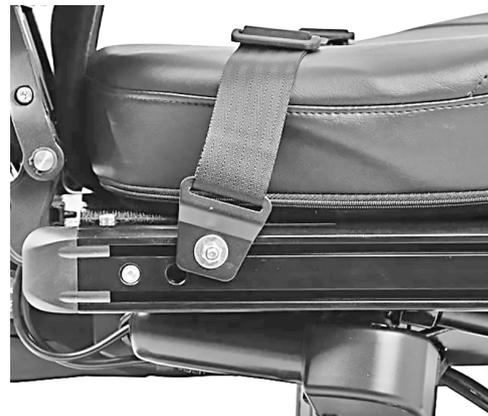
Foto 148. Abroche del cinturón de posicionamiento
