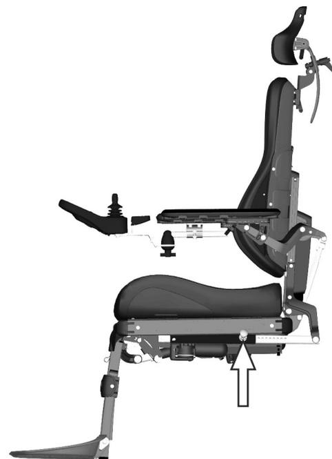
Foto 18. Tubo de abrazadera manual para reclinar el respaldo.
