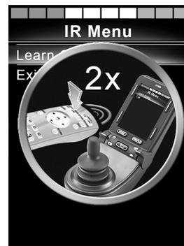
Foto 74. Apunte el control remoto hacia el receptor IR. Pulse el botón dos veces.
