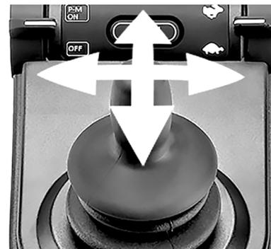
Foto 67. Con el uso de Bluetooth®, el joystick puede controlar las funciones del ratón.
