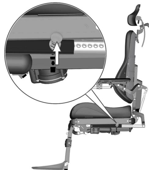
Foto 19. Ajuste manual del ángulo del respaldo.
