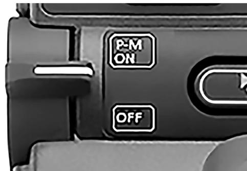
Foto 30. Interruptor de palanca de la alimentación, modo y perfil.
