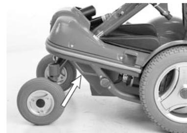
*Illustration 92. Œillets de fixation arrière*
