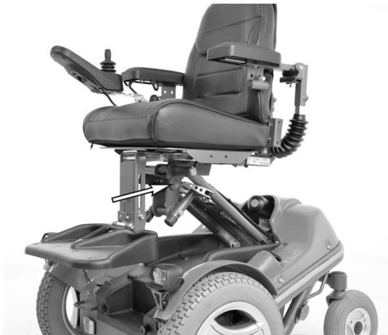
*Illustration 9. Élévateur électrique et dispositif de blocage de l'inclinaison d'assise.*
