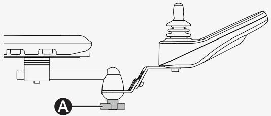
Puede ajustar el ángulo del panel de control giratorio hacia cualquier lado. Así se ajusta el ángulo.
