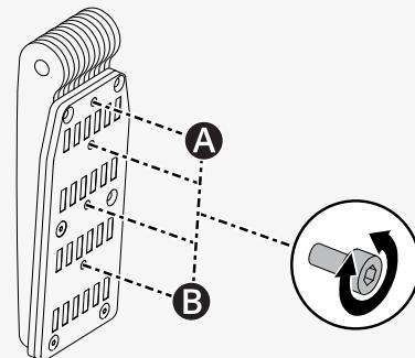
Así se ajusta la altura y la profundidad del reposacabezas.
