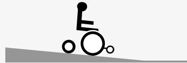
El centro de gravedad de la silla de ruedas cambia cuando se modifica la posición del asiento y/o del respaldo. Cuando levante o incline el asiento o el respaldo, o cuando utilice la función de bipedestación, disminuirá la estabilidad de la silla de ruedas.
