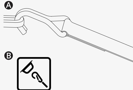
Después de haber fijado las correas en la silla de ruedas, fije el otro extremo de las correas en el vehículo según las instrucciones correspondientes. El accesorio de fijación de la correa debe cumplir la norma ISO 10542-1:2012, que es un estándar internacional que rige los sistemas de sujeción de ocupantes y puntos de sujeción de sillas de ruedas. Cada sistema de sujeción de vehículo es diferente y es importante que siga las instrucciones del sistema de su vehículo particular.
