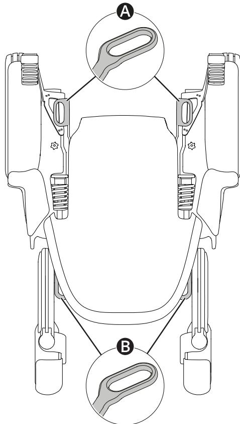
La silla de ruedas está equipada con cuatro puntos de sujeción para el transporte. Dos en la parte delantera **A** y dos en la trasera **B**.
