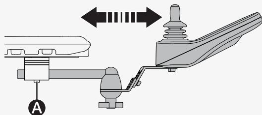
Así se ajusta la resistencia del soporte del panel giratorio.
