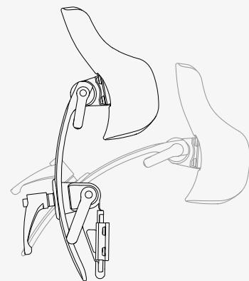
Así se ajusta la altura y la profundidad del reposacabezas.
