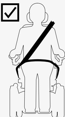
El dispositivo de sujeción con cinturón para el hombro debe colocarse sobre el hombro. El dispositivo de sujeción con cinturón para la pelvis debe colocarse a lo largo de la pelvis y en la zona que desee con un ángulo de 30° a 75°. Es preferible tener un ángulo más inclinado en la zona que desee. Asegúrese de que la silla de ruedas no está levantada ni inclinada. La silla de ruedas debe estar en la posición que se muestra en la imagen.
