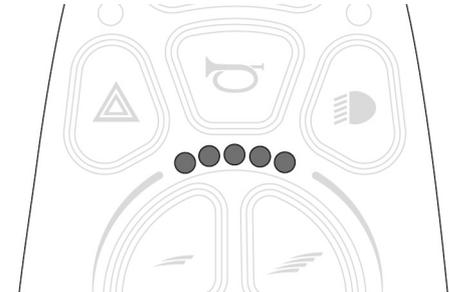
Abbildung 87. Anzeige für Höchstgeschwindigkeit
