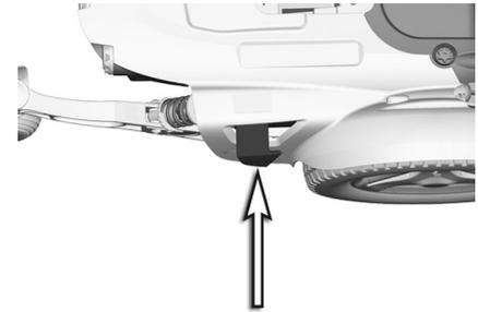
*Abbildung 99. Zurücksetzen entriegelter Bremsen*
