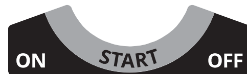
Illustration 25. Étiquette pour le disjoncteur principal et la touche de démarrage.
