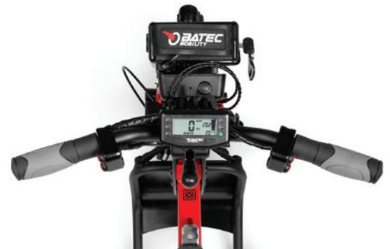
**G&B (Gas und Bremse)-Lenker** für Tetraplegiker. Bremsen und Beschleunigen mit einer leichten Vor- und Rückwärtsbewegung des Lenkers.
