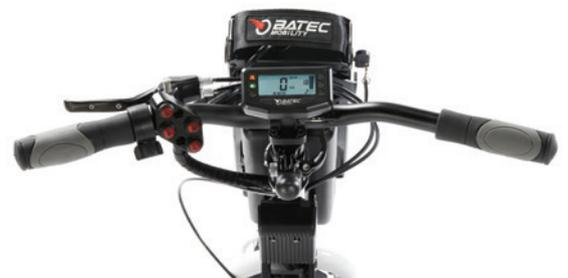
**Bedienelemente am Lenker** angepasst für hemiplegische Benutzer. Bedientasten und Bremsgriffe können je nach Bedarf auf der linken oder rechten Seite angebracht werden.
