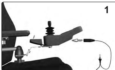
*Raccordement du câble d'urgence sur la prise de courant de charge*
