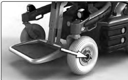
*Valve de chambre à air, pneu avant*
