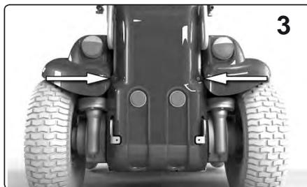
*Vis à six pans creux servant à fixer le capot arrière*
