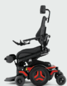
Voorwaartse kantelverstelling Active Reach* 5-20° Voor 20° is een VS-beensteun nodig
