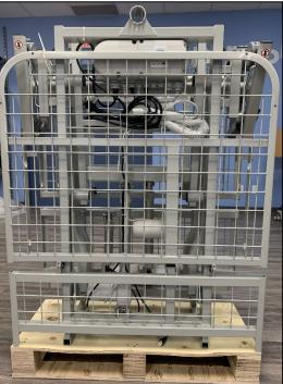
4 - Sur le côté de la palette d'emballage, retirez, au moyen d'une clé hexagonale de 6 mm, les vis de chaque côté d'une première plateforme d'assemblage : cette mesure détache la plateforme de lit du support d'emballage. La plateforme compte deux vis (une de chaque côté).
