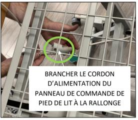
4 - Abaissez le dispositif de verrouillage de la rallonge sur la connexion du panneau de commande de pied de lit afin de verrouiller les câbles.
