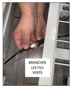
5 - Si vous devez débrancher les fils ultérieurement, appuyez sur la partie blanche des connecteurs de la section de pied et séparez doucement les connecteurs. Aux fins de l'assemblage, laissez les fils branchés.
