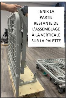
6 - Au moyen d'une clé hexagonale de 6 mm, retirez les vis de chaque côté de l'autre plateforme pour la détacher du support d'emballage. Soulevez la deuxième plateforme hors de la plaquette et déposez-la au sol, les roues vers le bas.
