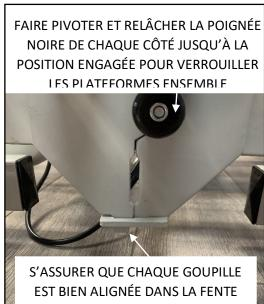
9 - Les plateformes doivent être bien fixées ensemble et le lit doit être à plat.
