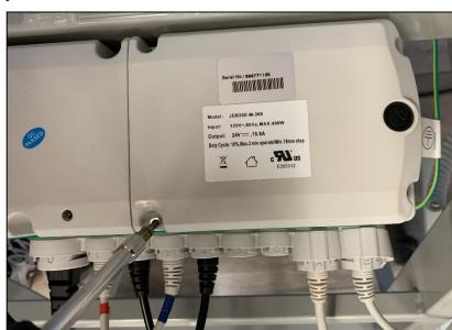
13 - Repliez les fils à l'intérieur du boîtier et vissez le couvercle.
